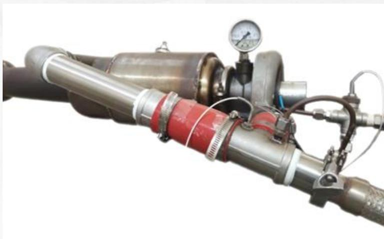
**10kW微型燃气轮机**
